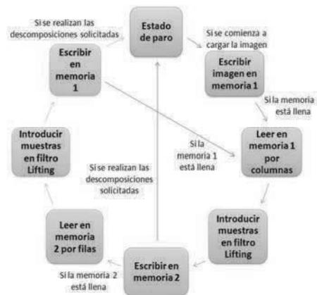
Figura 6: Funcionamiento del diseño completo Lifting
