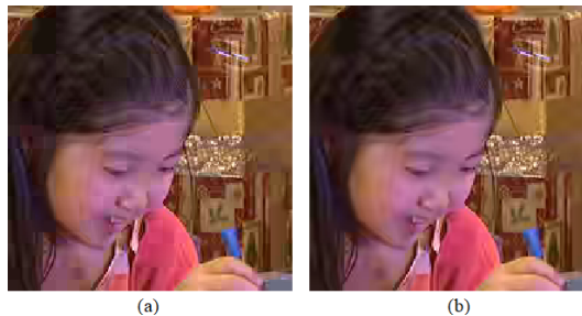
Fig. 2: Ejemplo de uso del filtro de deblocking en un frame de BlowingBubbles codificado con QP=37: (a) DB deshabilitado, (b) DB habilitado.
